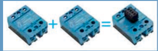
2-Phasenrelais SOB zum Schalten von Heizungen in Dreieckschaltung. Für hohe Spannungen, auch für unsymmetrische Belastung.
